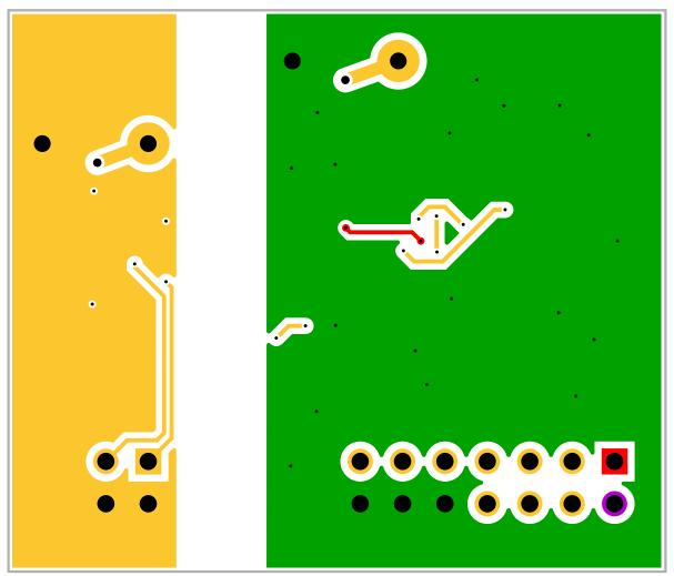
FIGURE 10. ISL6752 CONTROL CARD BOTTOM LAYER
