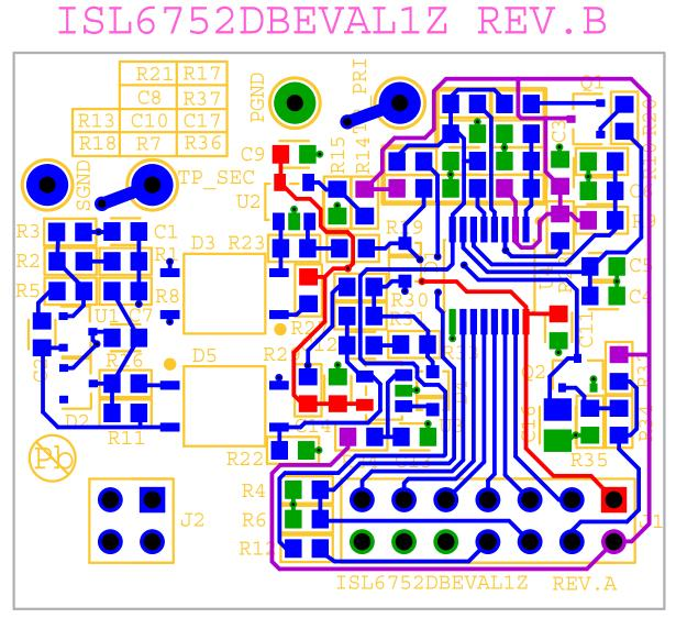
FIGURE 9. ISL6752 CONTROL CARD TOP LAYER
